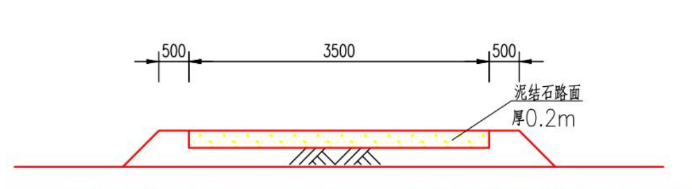
图 2-9 施工临时道路典型断面图
