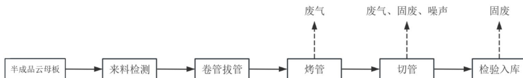
图 2-4 云母管工艺流程及产污节点图
