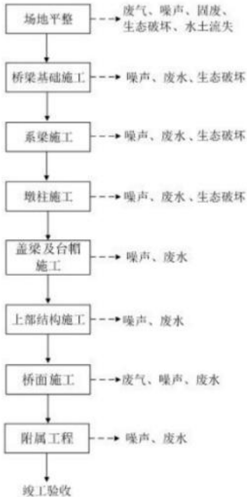
图 2-12 桥梁工程主要工艺流程及产污环节示意图
