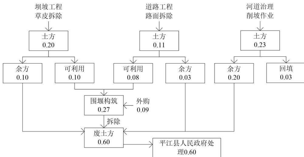
图 2.2 本项目土方平衡图 单位：万 m<sup>3</sup>
