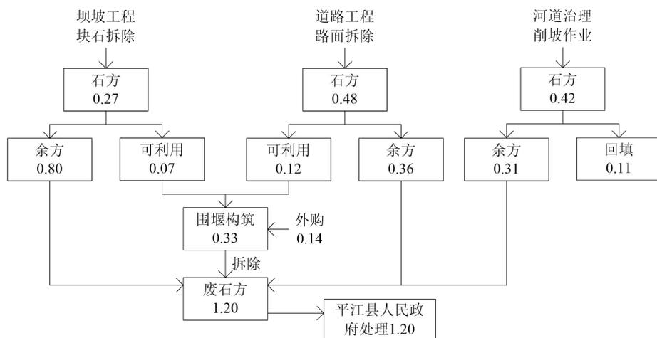
图 2.3 本项目石方平衡图 单位：万 m<sup>3</sup>
