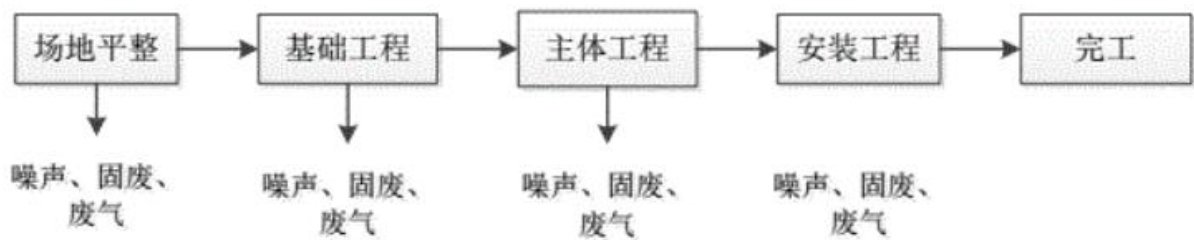
图 5-2 厂房施工流程及产污节点图
