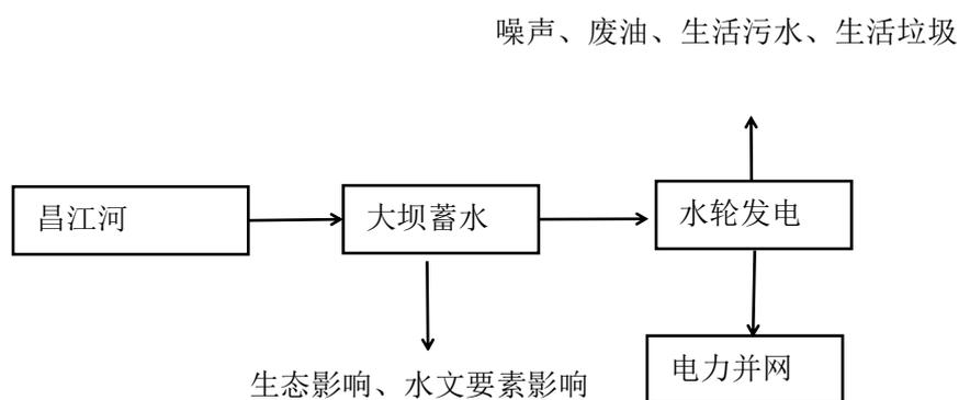
图 2.4-1 工艺流程及产污节点图
