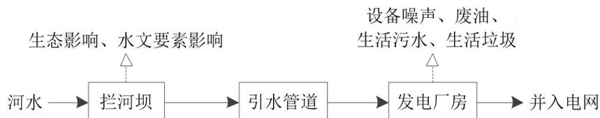
图 5-1 工艺流程及产污节点图
