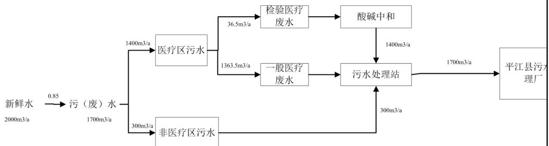
图 2-1 项目水平衡图 单位：m<sup>3</sup>/a
